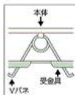
※取り付けるときは片方ずつVパネを絞りながらカバーの金具に押し、最後にカバーを押し上げ固定する。
